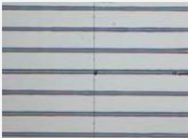
线幅3 \mu\text{m} 的线条绘制 (Resist)
